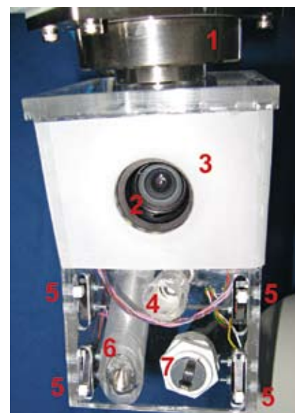
Abb. 1.4-2: Messkopf am Ende des Roboterarms
