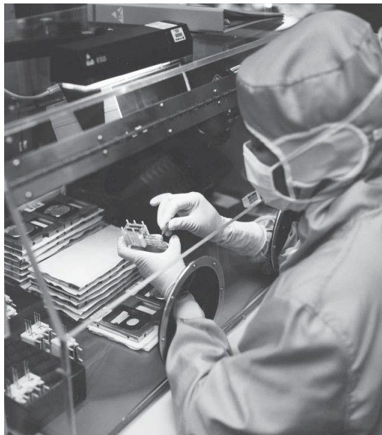
Abbildung 7: In Höchstreinräumen werden die Impulsgeneratoren weitgehend in Handarbeit gefertigt. Mit freundlicher Genehmigung der Medtronic GmbH
