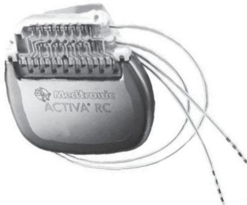
Abbildung 8: Impulsgenerator Medtronic Activa RC: 54 mm hoch, 54 mm breit, 9 mm dick und 40 Gramm leicht Mit freundlicher Genehmigung der Medtronic GmbH
