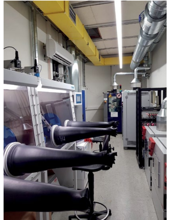
Abb. 2: Batterielabor am INES: Im Vordergrund ist die Glovebox zur Öffnung und Präparation von Batterien zu sehen, im Hintergrund Temperaturprüfschränke. Bild: Mehmet Yagci, Hochschule Offenburg
