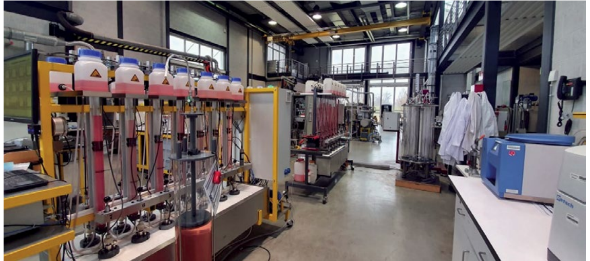
Abb. 3: Biogasgärteststände an der Hochschule Offenburg. Mit diesen Apparaturen lassen sich die Einflüsse von Enzymen bei der Methanisierung von Bioabfällen untersuchen. Die Ergebnisse können dazu verwendet werden, die Einflüsse in realen Biogasanlagen im Produktionsmaßstab zu erkennen.
