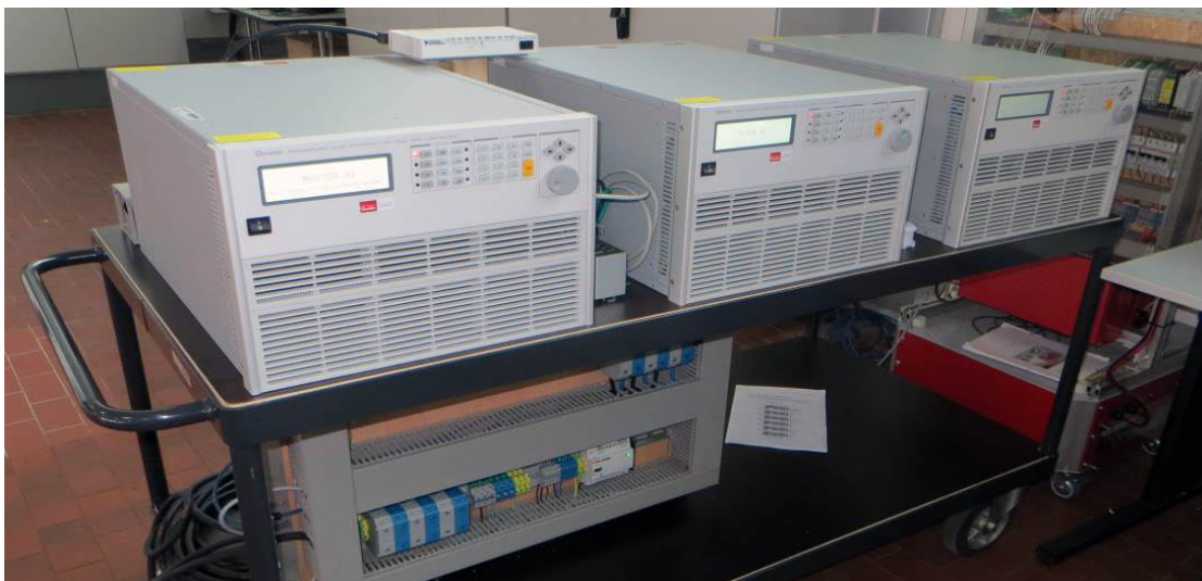
Abbildung 2-53: Testaufbau mit elektronischen Lasten zur Abbildung eines RLC-Lastprofils für ein dreiphasiges Drehstromnetz
