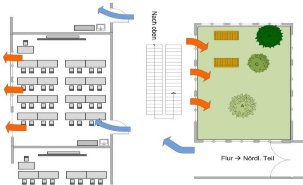
**Abbildung 3.5-2: Temperaturlüftung durch freie Lüftung über einen Innenhof und über die Oberlichter des Klassenzimmers. Kühle Luft strömt aus anderen Gebäudeteilen nach.**
