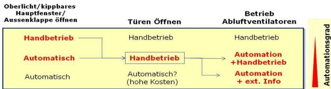
Abbildung 3.2-1: Empfohlener Automationsgrad zur Schaffung definierter Luftwege mit Hilfe bautechnischer Elemente
