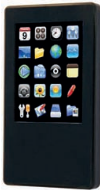
Abb. 1.3-1: PDA mit grafischer Touchscreen-Oberfläche, entwickelt an der Hochschule Offenburg mit dem eigenen Prozessorkern SIRIUS, 32 bit, 48 MHz, ca. 40 MIPS Leistung auf einem programmierbaren Cyclon III FPGA
