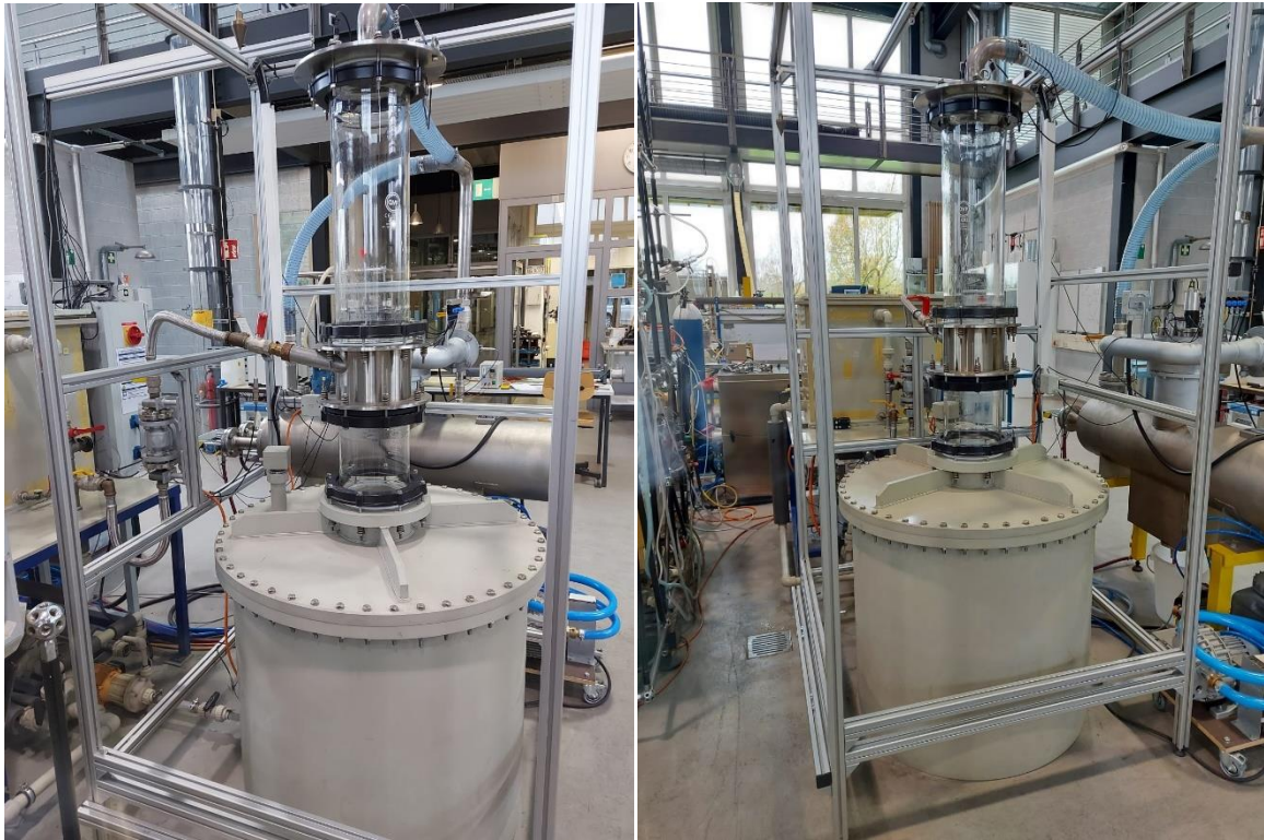
Abbildung 7: Kolonne mit Sumpfbehälter , Rückseitenansicht (links), Seitenansicht (rechts)
