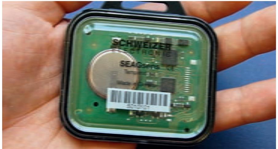
Abb. 1.4-1: Der SEAGsens Transponder in der Serienausführung
