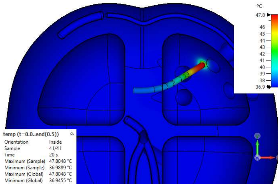
Abbildung 4.33: Simulation der Thermalfeld Ausbreitung nach 20 s an der LSPV bei 15W
