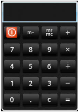
Bild 7: Taschenrechner Um die eingegebenen Zahlen und die Ergebnisse darzustellen, ist die Funktion writeString() zum Einsatz gekommen, welche Stringketten auf dem Display darstellt und zu der erstellten Schriftarten-Bibliothek gehört.
