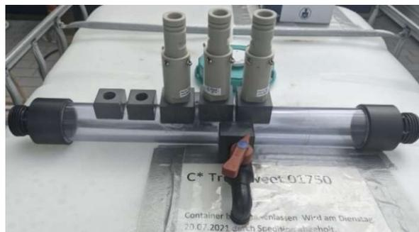
Abbildung 3: Messstrecke mit Schnellwechselarmaturen und Absperrhahn.
