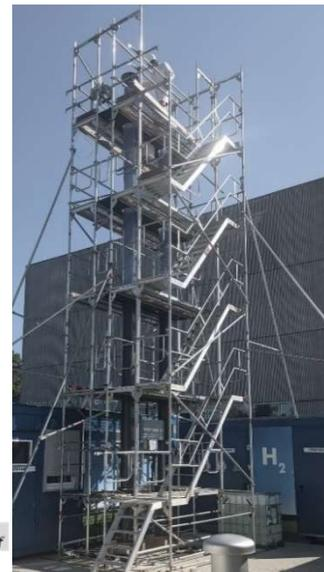
Abbildung 1: Fließschema zur biologischen Methanisierung in einer gepackten Gegenstromblasensäule mit separatem Entgasungs-Reaktor (A). Technische Umsetzung des Verfahrenskonzeptes mit einem Reaktionsvolumen von ungefähr  $1 \text{ m}^3$  (B).
