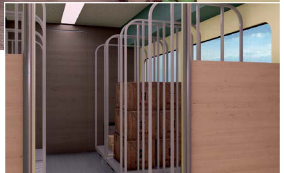
Abb. 2: Simulation Frachtraum auf Basis eines realen Stadtbahn-Fahrzeugs der AVG Karlsruhe (Projektseminar BW/Logistik und Handel SS2022)
