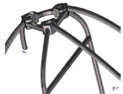
Abb. 1.6-3: Randbedingungen für die statische Belastungssimulation nach FIA-Reglement
