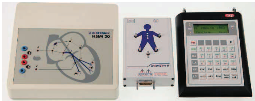
Abb. 1.3-1: Drei elektronische Herzrhythmusstimulatoren mit unterschiedlichem Parameterumfang. Von links nach rechts die Geräte HSIM 20 (Biotronik, Berlin), Intersim II (Lang, Chemnitz) und der in diesem Beitrag genutzte ARSI-4 (hkp, Bannewitz) für Ausbildungszwecke und industrielle Simulationen an Herzschrittmachern und Defibrillatoren
