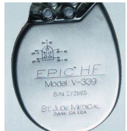
Abb. 1.3-2: Implantierbarer automatischer biventrikulärer Cardioverter/Defibrillator (AICD) vom Typ EPIC HF mit QuickOpt-Algorithmus zur Empfehlung einer optimalen AV-Delay-Einstellung für die Kardiale Resynchronisationstherapie (CRT)
