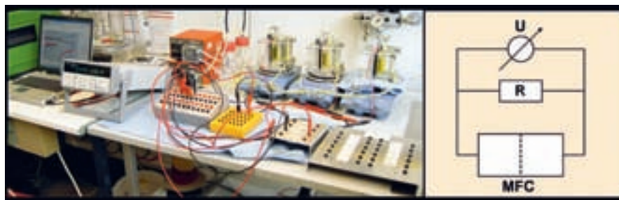
Abb. 3.4-3: Foto des Versuchsaufbaus (zur Bestimmung des Einflusses links) und Verschaltung der MBZ zur Ermittlung der Leistungsdichte (rechts). Auf dem Foto dargestellt (im Vordergrund v. l. n. r.): Messwertaufnahme, Multimeter mit Verkabelungsbox, variable Widerstände. Im Hintergrund v.l.n.r.: Schlauchpumpen zum Befüllen der Kompartimente; drei mikrobielle Brennstoffzellen (Screeningzellen)
