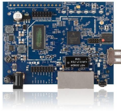
Darstellung 27. Anschlüsse und Platine des Dragino LG01-Gateways [75]
