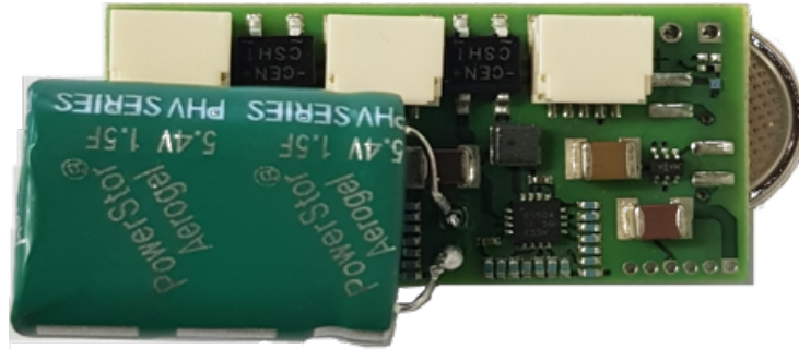
Abbildung 7: Energieversorgungsmodul mit Kondensator und Batterie
