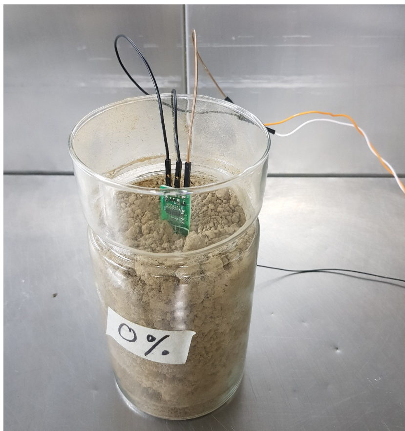
Abbildung 24: Messung der Bodenfeuchte mit einem Giesomat-Sensor
