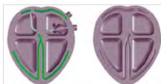
Abb. 3: CAD-Modell – unterer und oberer Teil des Druckmodells
