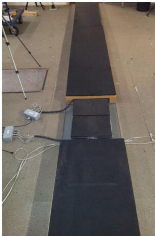
Abbildung 19: Aufbau Laufsteg (Alexis Brinkemper, 2013, S.18)
