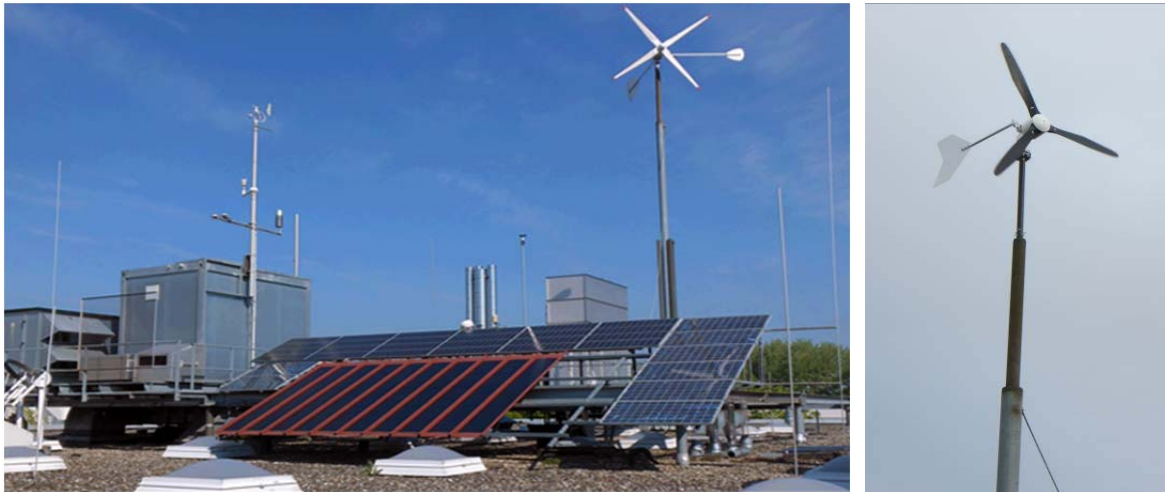
Abbildung 1: Die Außenanlagen der Energieinsel als Teil des Testfelds für erneuerbare Energietechnik und Wettermeßtechnik am Hauptcampus der Hochschule Offenburg. Rechts: Windgenerator seit 2015
