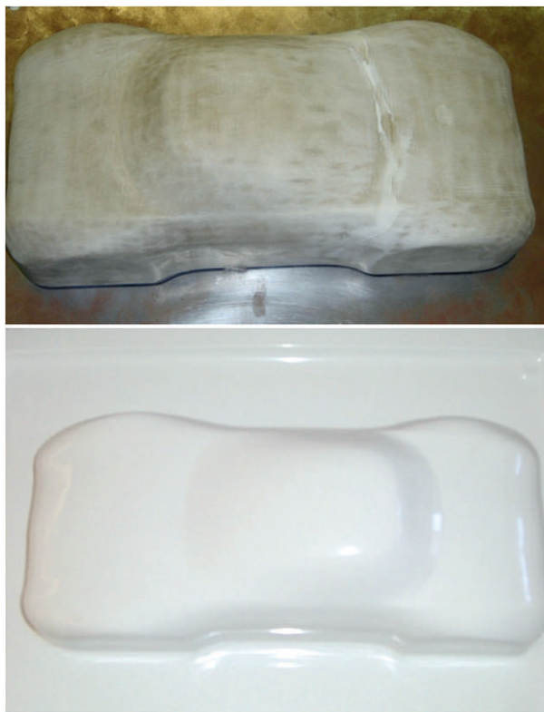
Abb. 5.3-2: Formwerkzeug zum Thermoformen eines Automobilmodells („Schluckspecht“) (oben) und umgeformte Kunststoffolie
