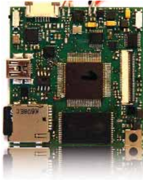
Bild 2: Multilayer-Platine des PDA mit SIRIUS-JANUS als UMC-ASIC, \mu SD-Card, USB-Interface, Touch Interface, OLED-Interface und RFID-Reader, 2010
